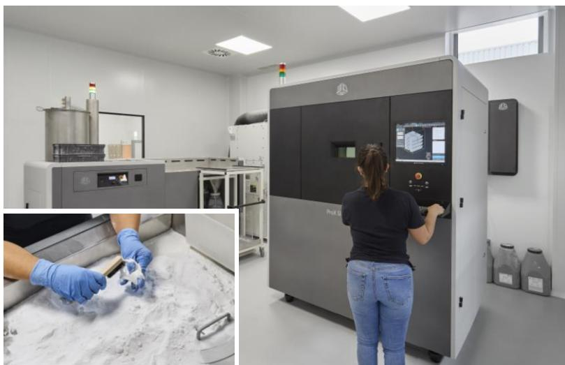
ProX SLS 6100, da 3D Systems, com capacidade de construção máxima de aproximadamente 381 x 330 x 460 mm (c x l x a).
